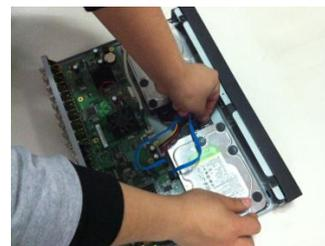
4. Coloque el DVR boca abajo y apriete los tornillos con firmeza.
